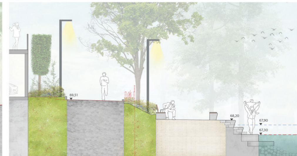
Schnitt B-B M 1:50 Ufer Nord
